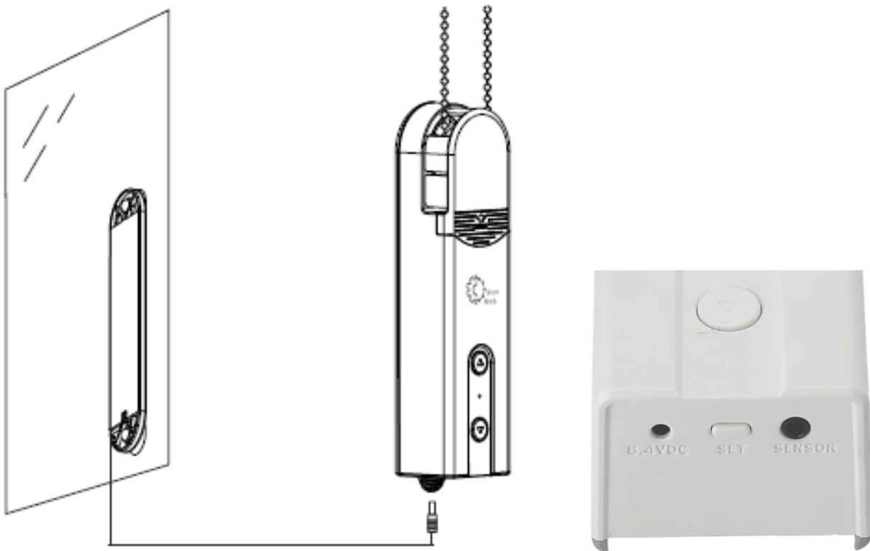
Das Solarpanel lädt die Batterie des Motors ständig auf, so dass ein Aufladen mit einem Ladegerät nicht erforderlich ist. Es ist jedoch kein Ersatz für ein Ladegerät, da seine Leistung nicht ausreicht, um eine vollständig entladene Batterie aufzuladen. Die Ladeleistung hängt von der Sonneneinstrahlung ab, d.h. an bewölkten und winterlichen Tagen ist die Leistung geringer als an sonnigen und sommerlichen Tagen.
