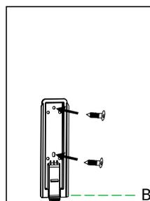
Прикрепить монтажную планку к поверхности с помощью винтов.
