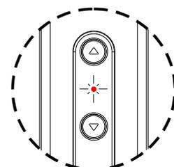
Сигнальная лампочка загорится красным светом (устройство в режиме опций).
