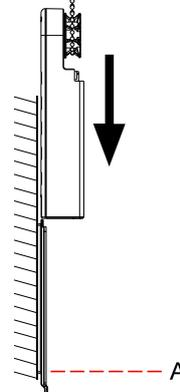
5.6.1. Расположить мотор на направляющих на монтажной планке.
