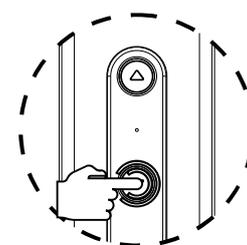
Нажать кнопку еще раз. Мотор останавливается.
