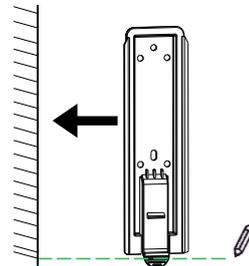
Приклеить монтажную планку согласно обозначенному положению В
