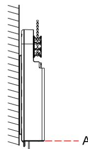
5.6.2. Подвинуть мотор, чтобы натянуть цепочку в положении А.
