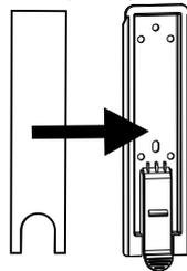
Выдвинуть монтажную планку и приклеить на нее монтажную ленту.
