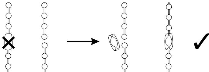
Если на цепочке есть соединитель (соединители), его (их) необходимо снять, а соединитель концов цепочки заменить на металлический
