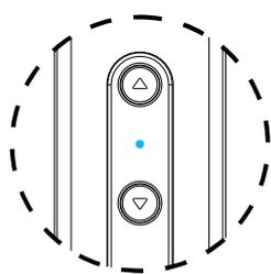
Сигнальная лампочка трижды мигнет синим светом (устройство выключено).
