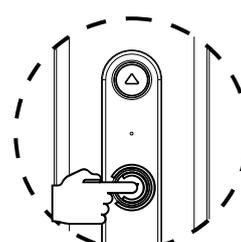
Нажать и придержать соответствующую кнопку в течение менее 1,5 секунд. Мотор прекратит вращаться после отпускания кнопки.
