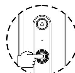
Нажать и придержать соответствующую кнопку в течение более 1,5 секунд. Мотор прекратит вращаться после повторного нажатия кнопки.
